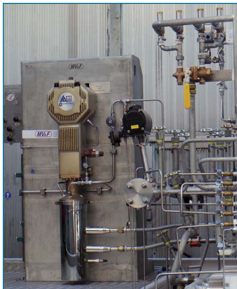
Рис. 8. Криогенный поршневой насосный агрегат MV&F высокого давления во взрывозащищённом исполнении в составе мобильной СКПГ-станции
