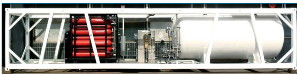
Рис. 3. Станция регазификации СПГ производства MV&F для заправки автомобилей КПП
