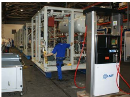
Сборка АГНКС на заводе LMF в Леоберсдорфе
